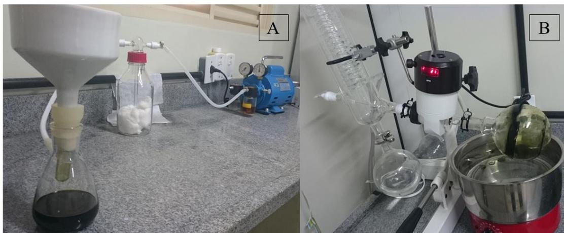
**Figura 2:** A: Filtragem à vácuo de solução extrativa de *Chenopodium ambrosioides* L; B: Evaporação de solvente em evaporador rotativo.
